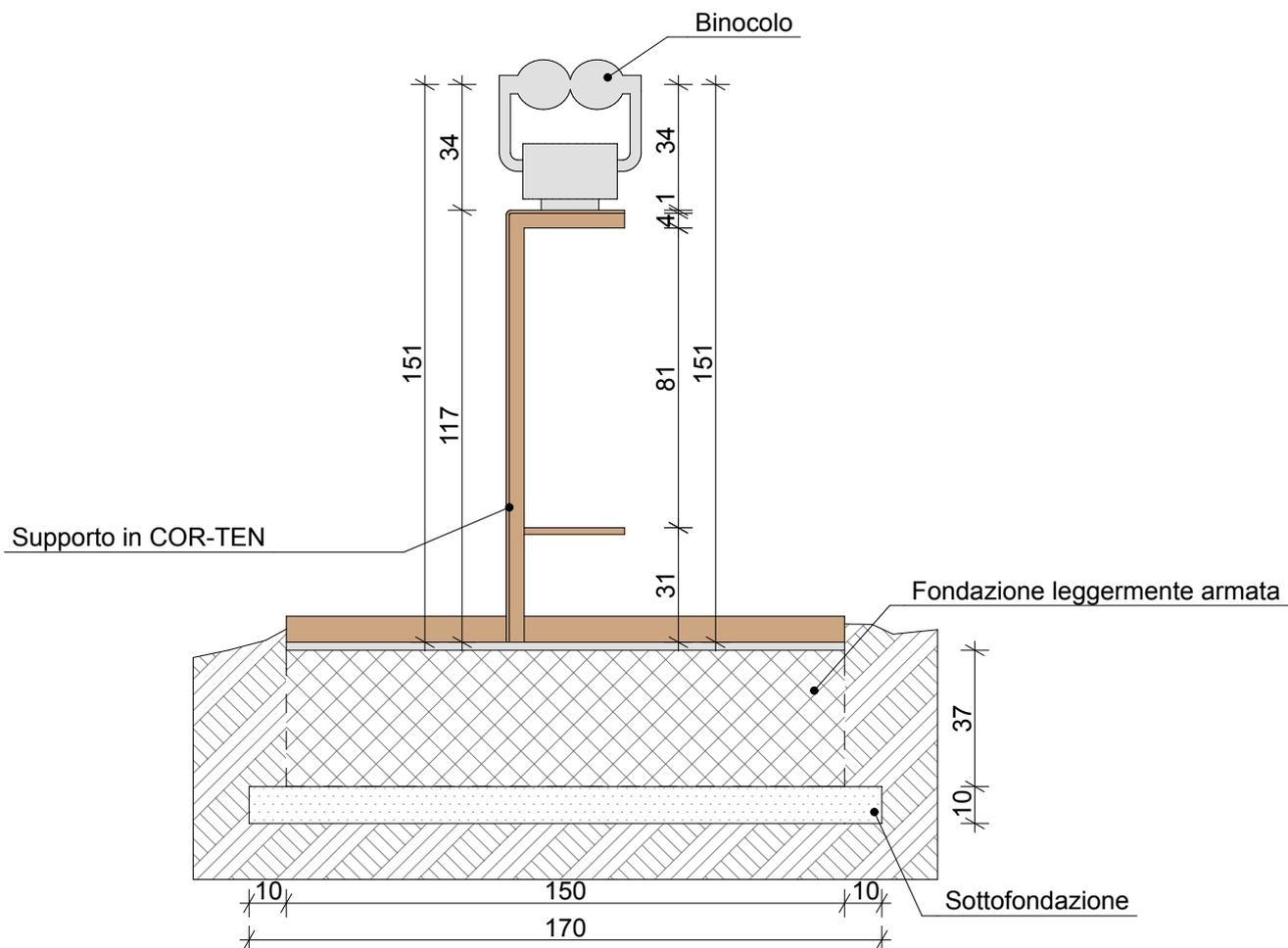
Vista AA struttura con basamento scala 1: 20
